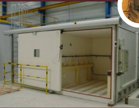
Essais de brouillard salin (13 m 3 )
