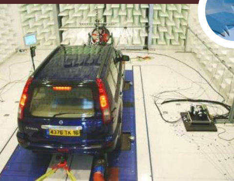
Essais de bruit au passage simulé
