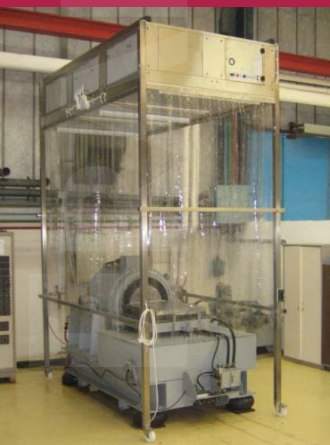
Plafond soufflant sur vibreur (classe particulaire 100)
